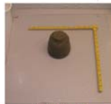
High yield cement Mini slump mortar: 105/110 mm Yield stress mortar: 500-600 Pa Plastic viscosity mortar: 8-10 Pa s Production date: 17.01.2007
